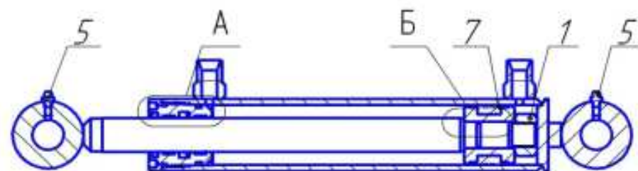
Гидроцилиндр ЦГ-ПМК-50.28.200.435-Е9-Р15 (Номер при заказе ЦГ-50.28-0001)
